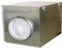
TLP состоит из вентилятора, фильтра и нагревателя, размещенных в корпусе из оцинкованной листовой стали (изоляция 50 мм минеральной ваты). В агрегате TLP используются вентиляторы серии K или KD, они сочетают компактность с хорошими аэродинамическими характеристиками. Двигатели вентиляторов имеют встроенные термоконтакты с электрическим перезапуском.
